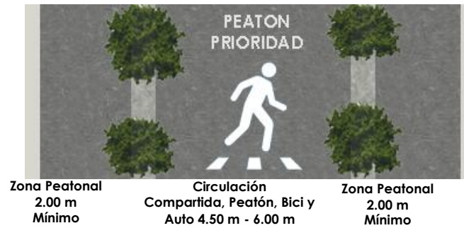
*Esquema tipo de sección, vialidad secundaria, menor de 10mts.
