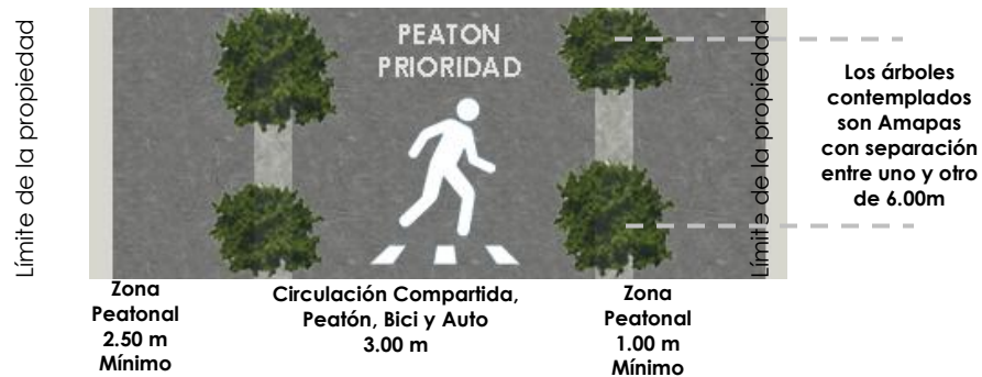
*Esquema tipo de sección, vialidad secundaria de 6mts.
