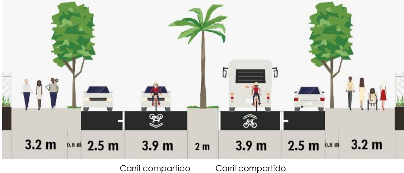
Imagen 9. Sección Total: 22.8 m Arroyo vehicular: 11 m Banquetas: 4 m mínimo
