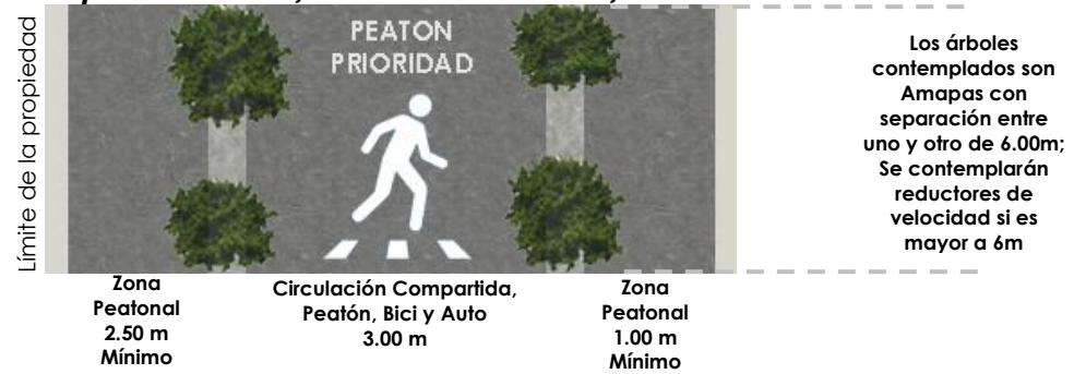
*Esquema tipo de sección, vialidad secundaria de 6mts.
