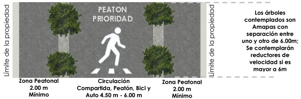
*Esquema tipo de sección, vialidad secundaria, menor de 10mts.
