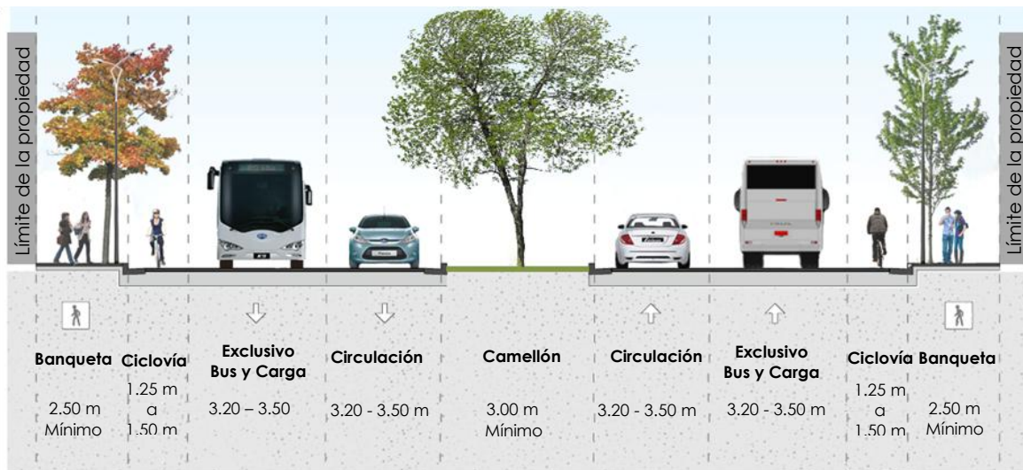
*Esquema tipo de sección, vialidad de estructural. SIN ESTACIONAMIENTO.
